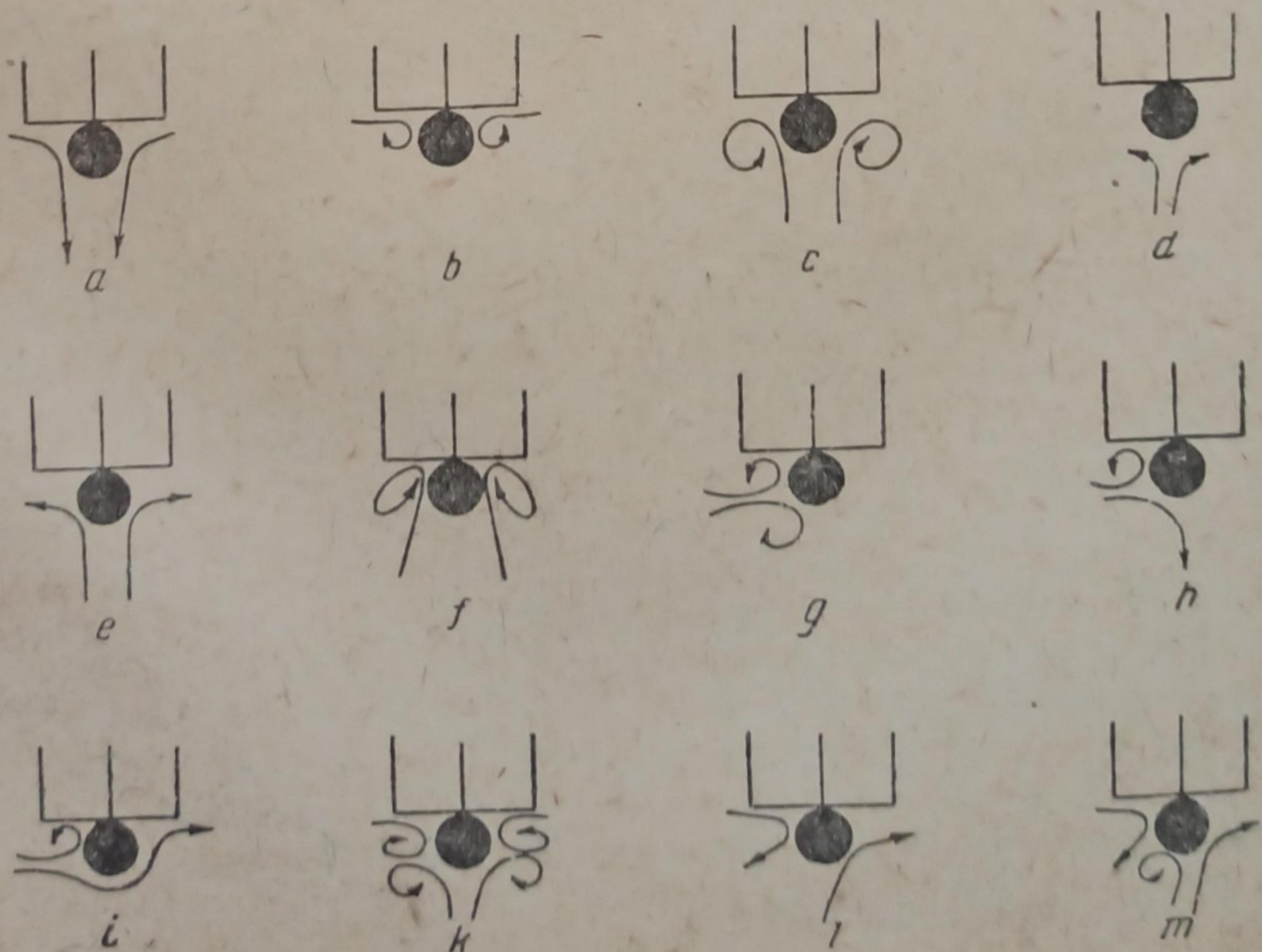
Рис. 5. Схематическое изображение различных форм движений электролита
