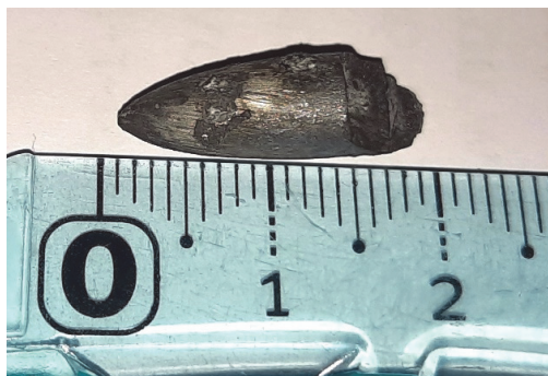
Рис. 14. Пуля, извлеченная из бетонного образца
