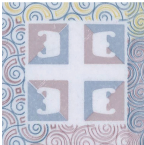
Рис. 5. Совмещающееся изображение. Вид в проходящем свете. Элементы на лицевой и оборотной стороне совмещены и образуют цельное по сюжету изображение без пробелов, накладок и сдвигов (паспорт Сербии, 2008 г.)
