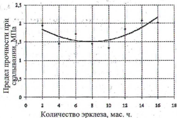
Рис. 3. Зависимость прочности клевого соединения фанеры от количества эрклеза до вымачивания в клеевой композиции (температура прессования 130°C)
