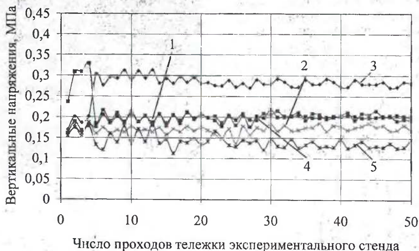
Рис. 8. Зависимость максимальных вертикальных напряжений от числа проходов тележки на участке с уложенной после 4-ого прохода лентой из изношенных автопокрышек: 1 – мессдоза № 2883; 2 – мессдоза № 2862; 3 – мессдоза № 3261; 4 – мессдоза № 2885; 5 – мессдоза № 3662
