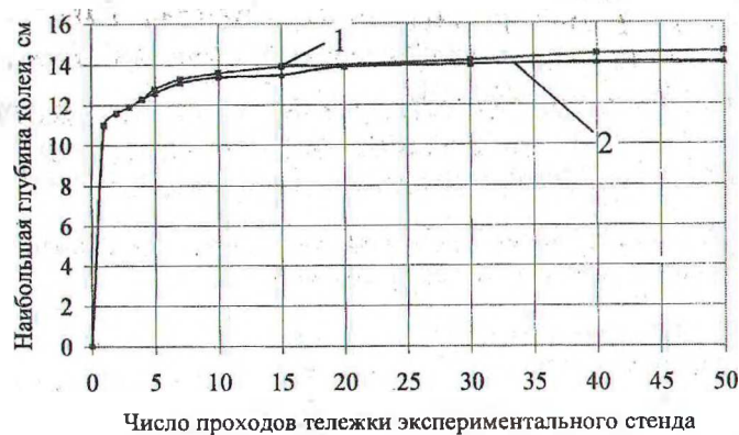
Рис. 9. Зависимость глубины колеи от числа проходов тележки: 1 – для участка без ленты; 2 – для участка с уложенной лентой
