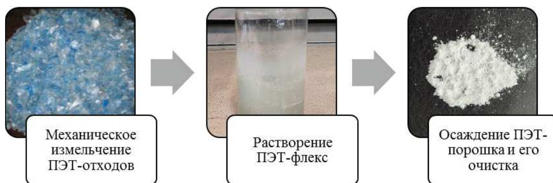
Рисунок – Схема получения полимерных порошков из ПЭТ-отходов
