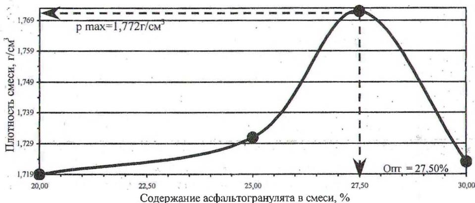
Рис. 4. Зависимость плотности щебеночной смеси от содержания в ней расклинивающей добавки – асфальтогранулята
