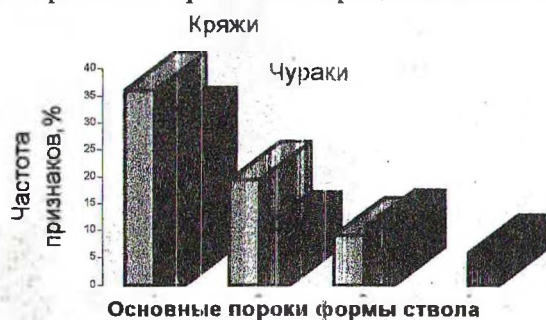
Рис. 4. Процентный состав пороков в объеме выборки: 1 – кривизна; 2 – закомелистость; 3 – сбежистость; 4 – овальность
