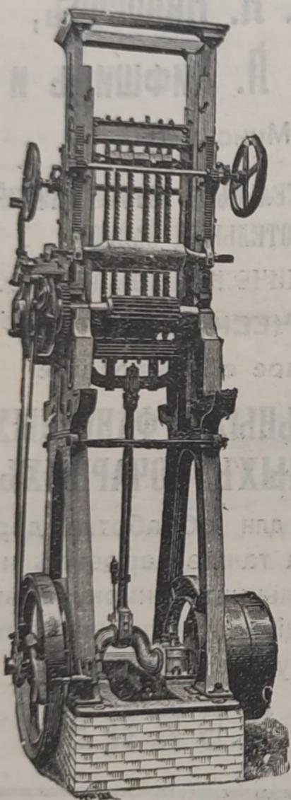
Строгальные станки новѣйшей конструкции и недостигнутой еще по сіе время производительности изготовляются въ болѣе чѣмъ 30 величинъ. Съ нашимъ строгальнымъ станкомъ № 12 была достигнута производительность въ 100000 футъ или 43000 аршинъ гребня и паза въ теченіе 10 час.
