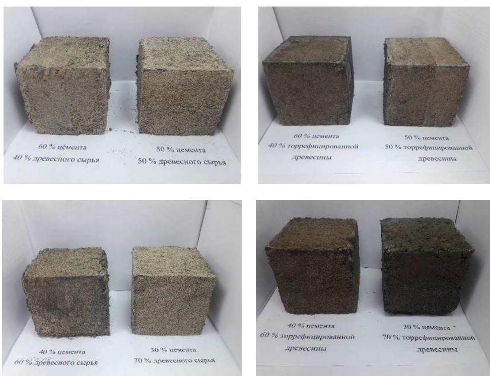
Образцы опилкобетона на цементном вяжущем с торрефицированной древесиной
