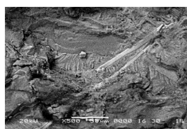
Рисунок 3 – Усталостный излом сплава 0052 при частоте испытаний 0,3 кГц
