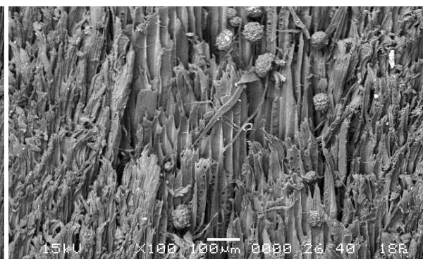
Рисунок 7 – Срез технологической щепы при \rho = 81 мкм
