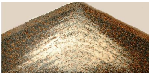
Рисунок 1 – Пример, фоторегистрации сегрегации сыпучего материала в куче [1]
