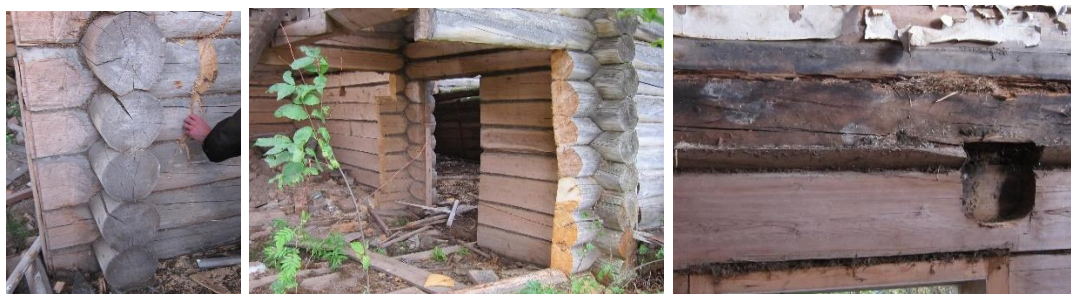
Рисунок 3 – Процесс сбора образцов ретродревесины в домах постройки 19 века
