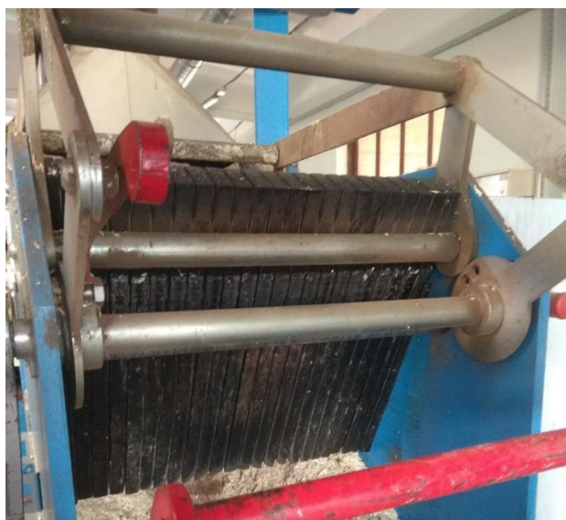
Рисунок 1 – Рычажная система подъема завес предохранительных упоров
