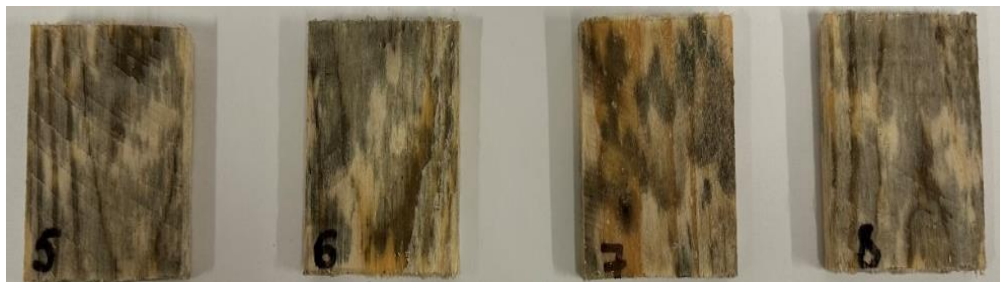
Рисунок 2 – Свежеспиленные образцы древесины, пораженные грибами
