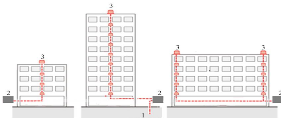
Рисунок 2 – Схема размещения газодинамического детонатора, блока и сейсмометрических датчиков управления
