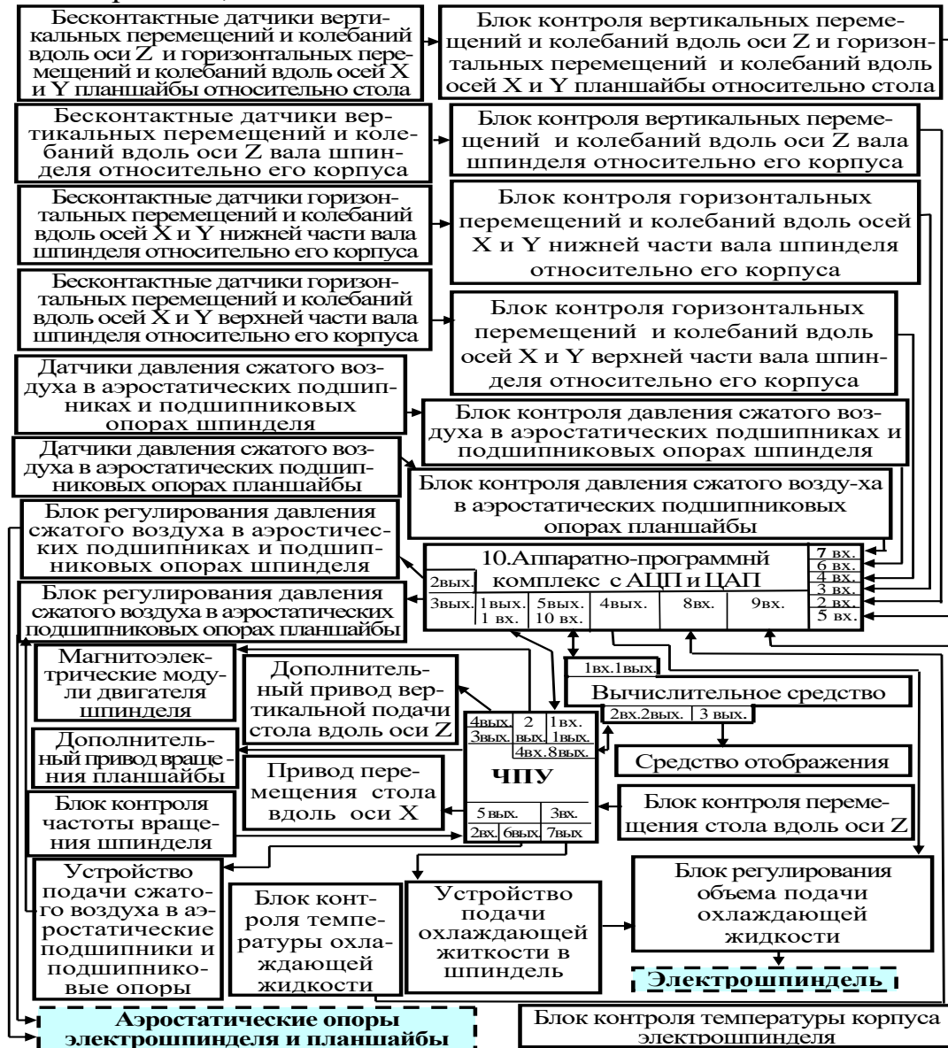
Рисунок 2 – Схема аппаратно-программных средств автоматизированной прецизионной обработки
