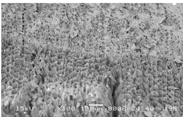
Рисунок 6 – Срез технологической щепы при \rho = 65 мкм
