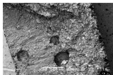
Рисунок 2 – Усталостный излом сплава 0051 при частоте испытаний 18 кГц
