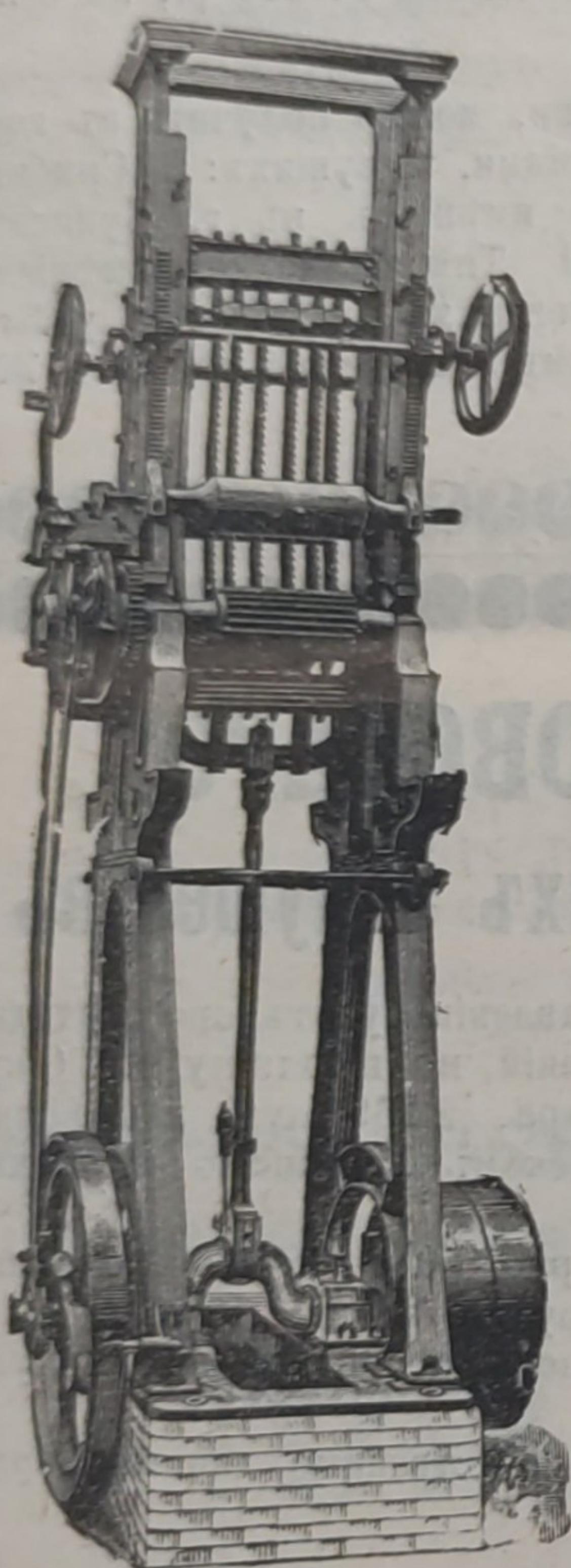
Строгальные станки новѣйшей конструкціи и недостигнутой еще по сіе время производительности изготавляются въ болѣе чѣмъ 30 величинъ. Съ нашимъ строгальнымъ станкомъ № 12 была достигнута производительность въ 100000 футъ или 43000 аршинъ гребня и паза въ теченіе 10 час.
