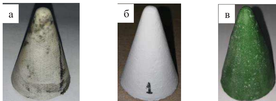
Рисунок 1 - Фотографии образцов до испытаний а – силикатное связующее, б – гибридное связующее, в – фосфатное связующее
