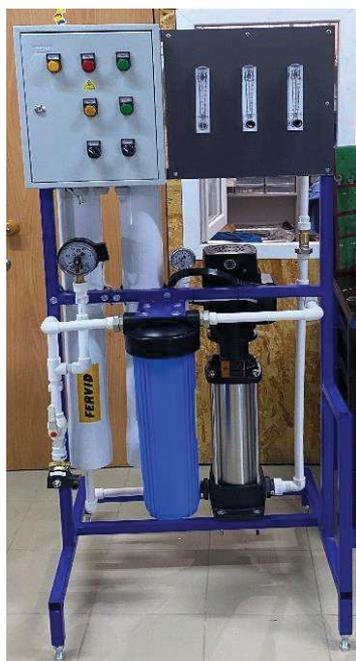
**Рисунок 1 – Внешний вид промышленной установки – обратный осмос**
