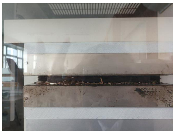
Рисунок 1 – Визуализация лабораторных исследований по изготовлению древесностружечных плит
