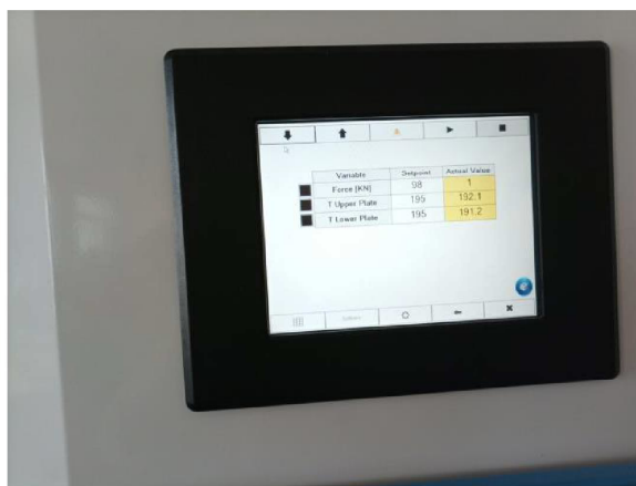
Рисунок 1 – Визуализация лабораторных исследований по изготовлению древесностружечных плит
