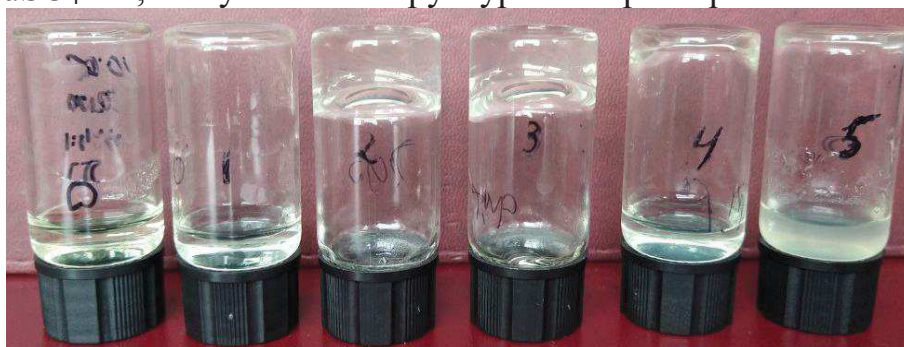
Рисунок 1 – Фото образцов ЦСР/CuSO 4 /ХЗ с различным содержанием CuSO 4 и ХЗ: 0; 0,015; 0,020; 0,025; 0,030; 0,025 мл на 1 мл ЦСР (слева направо), VХЗ/VCuSO 4 =1:1
