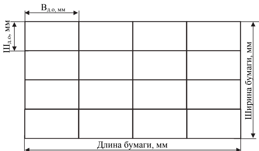
Рисунок 1.3 — Макет раскладки для 32-страничной тетради блока
