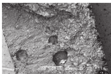
Рисунок 2 – Усталостный излом сплава 0051 при частоте испытаний 18 кГц
