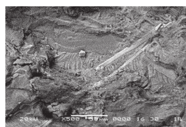
Рисунок 3 – Усталостный излом сплава 0052 при частоте испытаний 0,3 кГц
