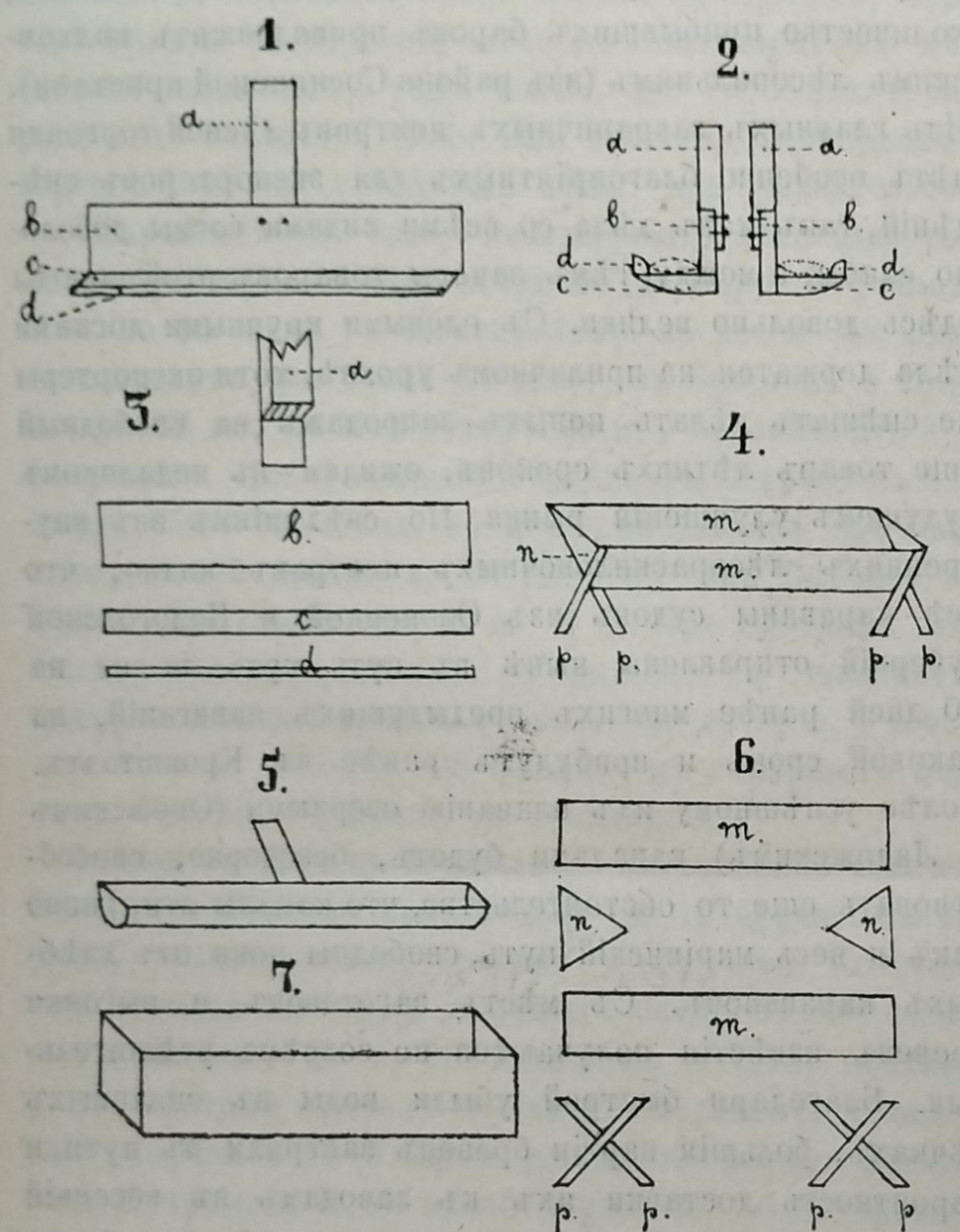
Этотъ приборъ можно сдѣлать и изъ жести—въ видѣ полуцилиндра съ діаметромъ 3—5 миллиметровъ (внутри полаго), чтобы въ него могъ помѣститься лишь одинъ слой сѣмянъ (рис. 5), а для насыпанія сѣмянъ сдѣлать ящичекъ (рис. 7). Длина прибора равняется ширинѣ гряды, т.-е.  $1\frac{1}{2}$  арш.; длина же ящика для сѣмянъ должна быть хотя на 1 верш. болѣе, чтобы въ него могъ свободно входить приборъ для взятія сѣмянъ.
