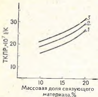
Рис. 1. Изменение ТКЛР композиционного материала на основе титалита в зависимости от вида и количества связующего материала:
