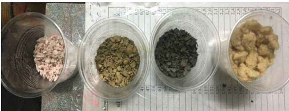
Рисунок 1 – Использованное сырье для производства композитных плит (слева направо: обувной картон марки СЦМ; обувной картон марки З-1; кожкартон марки КПЖ; древесное волокно)
