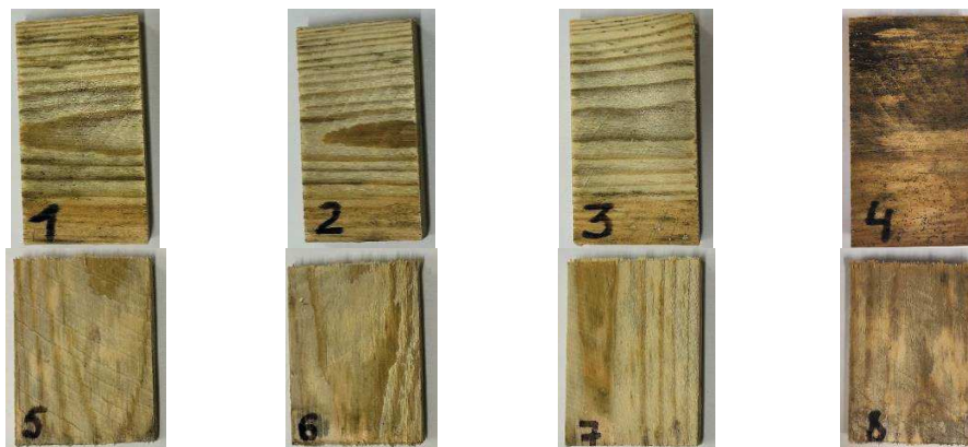
Рисунок 4 – Пораженные образцы древесины, обработанные составами для отбеливания древесины через 24 часа после обработки
