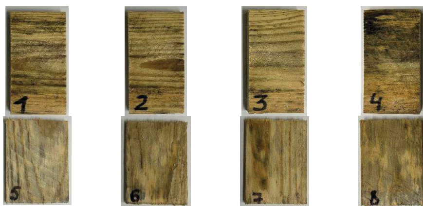
Рисунок 3 – Пораженные образцы древесины, обработанные составами для отбеливания древесины через 12 часов после обработки
