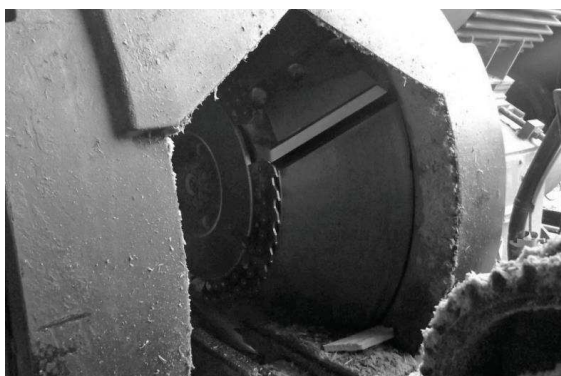
Рисунок 2 – Малоножевая торцово-коническая фреза фрезерно-брусующего станка
