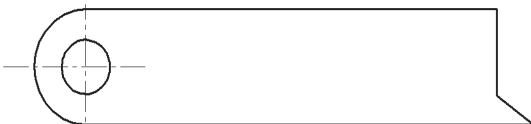
Рисунок 5 – Утяжеленный однозубый профиль
