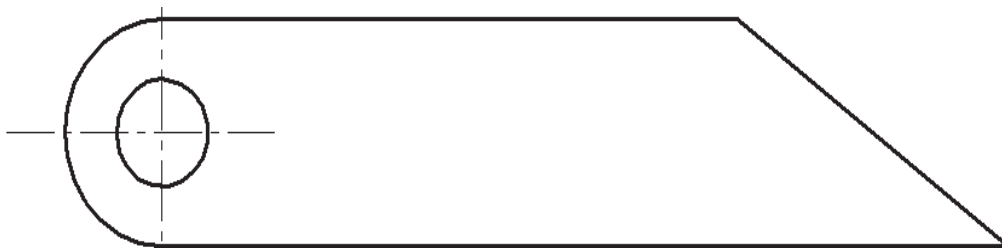
Рисунок 4 – «Классический» однозубый профиль
