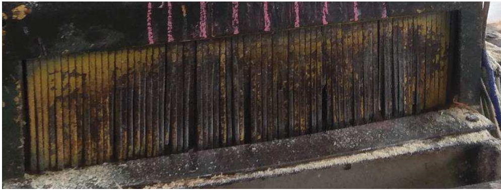
Рисунок 2 – Когтевая завеса станка ДСК-55
