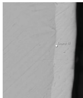
Рис. 6. Структура покрытия Ni–P и участок исследования химического состава на границе со сталью на образце № 2
