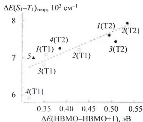
Рис. 5. Зависимость энергетического зазора  $\Delta E(S_1-T_1)$ , рассчитанного методом ZINDO/S, от энергетической расстройки  $\Delta E(\text{НВМО}-\text{НВМО}+1)$ : 1 —  $H_3K$ ; 2 —  $H_3TAlK$ ; 3 —  $H_3OAlK$ ; 4 —  $H_3PMe_2K$ ; 5 —  $H_2FП_2K^-$ ; в скобках указан таутомер
