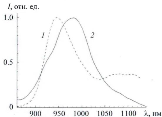
Рис. 4. Спектры фосфоресценции раствора 10-фенил-5,15-ди-(4,6-дихлоропиримидинил)-коррола при 77 К;  $\lambda_{\text{возб}} = 416$  (1) и 450 нм (2); спектры нормированы на максимум наиболее интенсивной полосы
