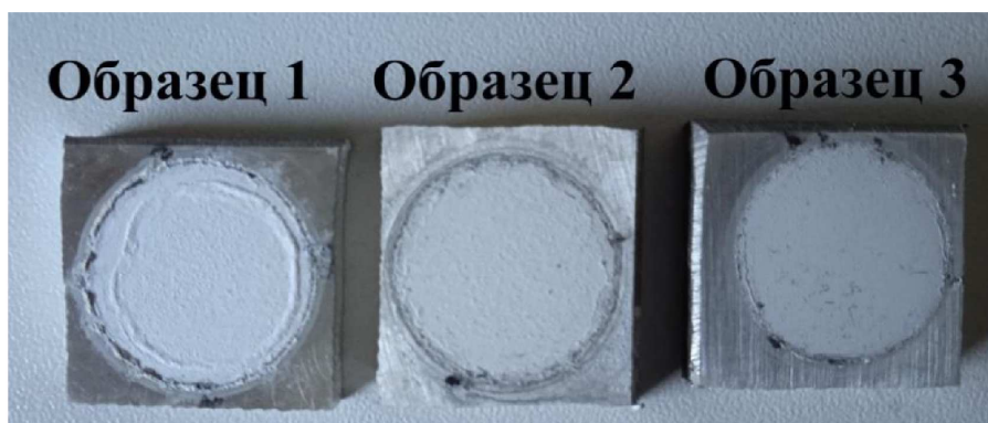
Рисунок 1 – Образцы сплава магния AZ91 после МДО
