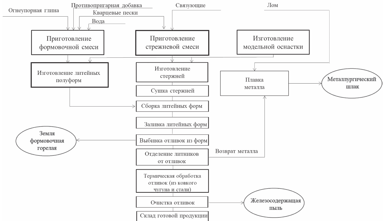
Рис. 1. Технологическая схема литейного производства
