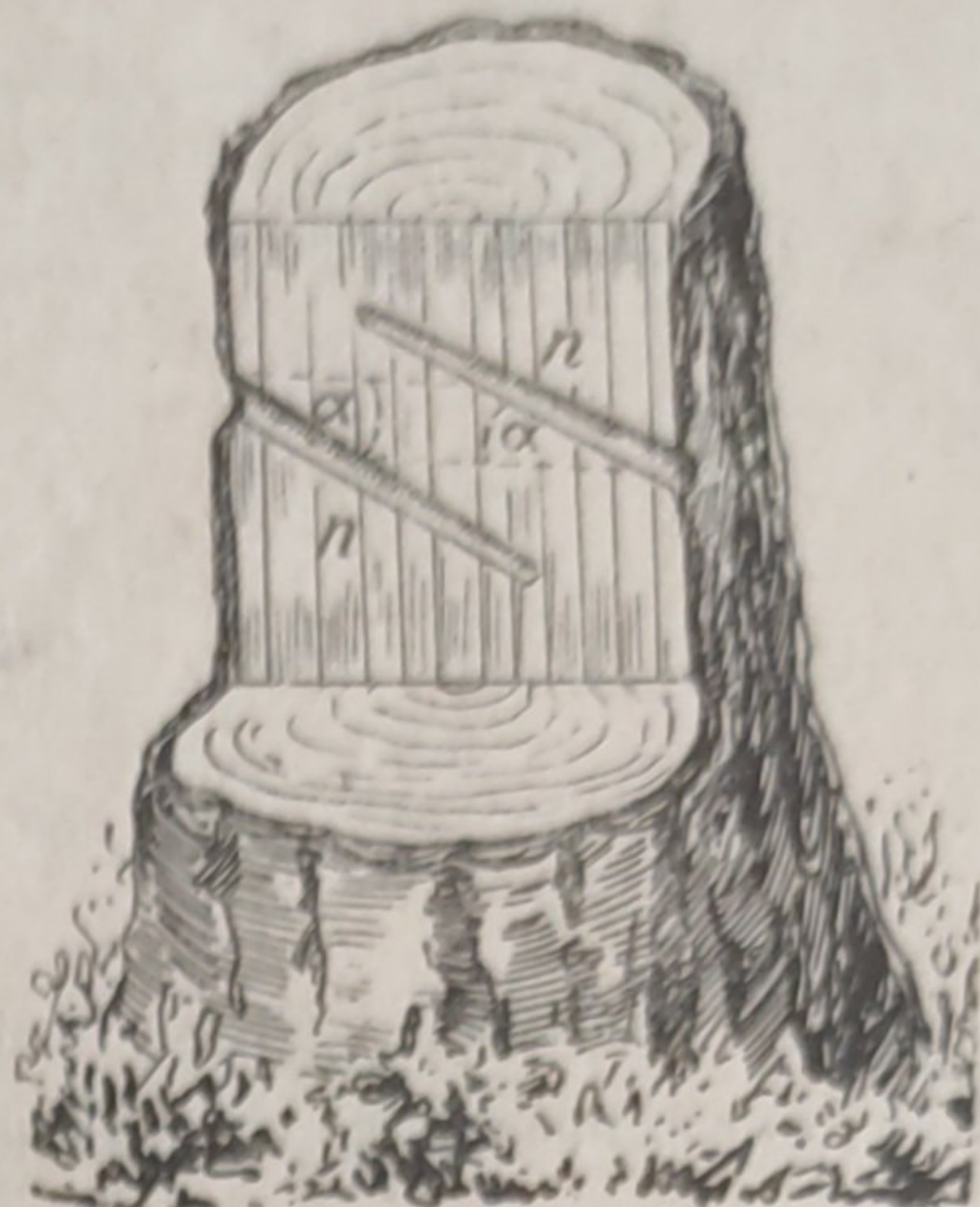
Рис. 4. Глубина канала на радиальном срезе ствола
