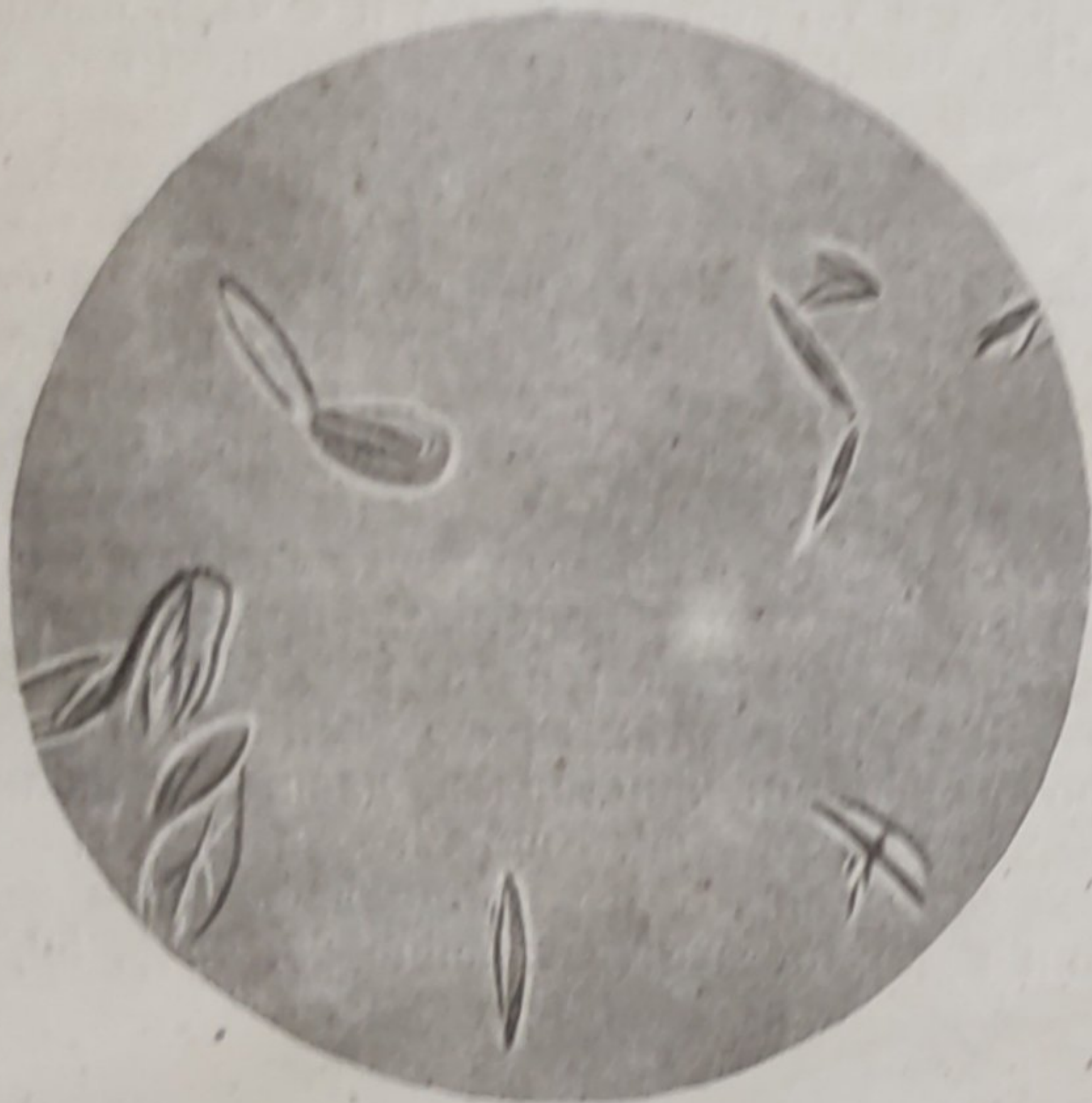
Фото 1. Кристаллы в канифоли Кусковского завода. Нагревание при 65^{\circ}\text{C} в течение 13 час. 45 мин.
