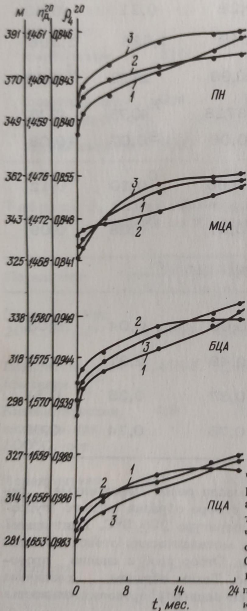
Рис. 1. Зависимость физико-химических показателей углеводородов: парафино-нафтеновых (ПН), моноциклоароматических (МЦА), бициклоароматических (БЦА), полициклоароматических (ПЦА), выделенных адсорбционно-люминесцентным методом из СМВ, от времени старения КГ: 1 — плотность при 20°С, г/см<sup>3</sup> (ρ<sub>4</sub><sup>20</sup>); 2 — показатель преломления (n<sub>D</sub><sup>20</sup>); 3 — молекулярная масса (M).
