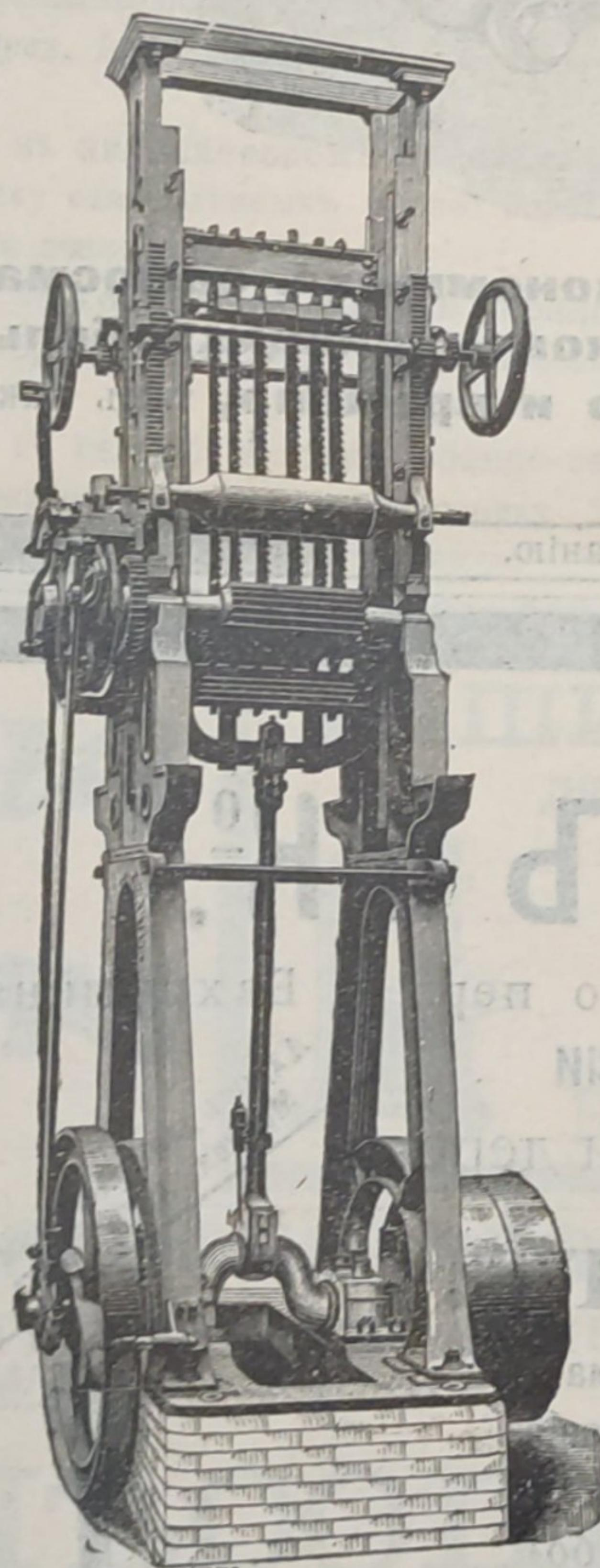
Строгальные станки новѣйшей конструкціи и недостигнутой еще по сіе время производительности изготавливаются въ болѣе чѣмъ 30 величинъ. Съ нашимъ строгальнымъ станкомъ № 12 была достигнута производительность въ 100000 футъ или 43000 аршинъ гребня и паза въ теченіе 10 час
