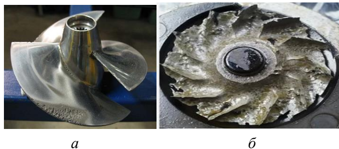
Рисунок 3 – Кавитационный износ a – лопастей ротора мешалки; б – ротора центробежного насоса
