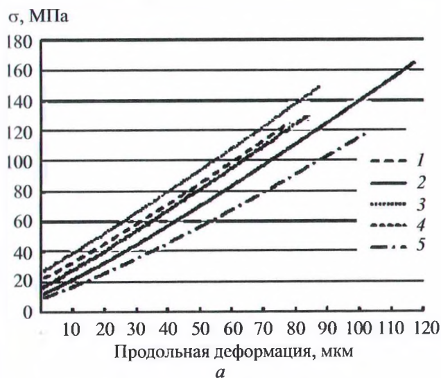
Рис. 3. Диаграммы деформации базальтовых стекол: 1 – базальтовое стекло; 2 – 10 – стекла модифицированных составов
