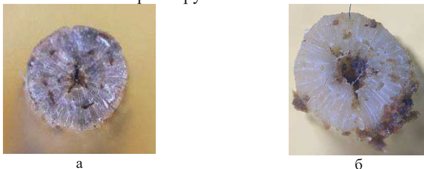
Рисунок – Дисколоризация древесины сосны в результате искусственной инокуляции грибами O. Minus (а) и O. Ips (б)
