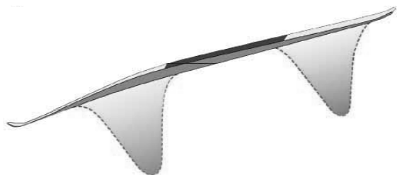
Рис. 4. Эпюра распределения нагрузки на теплой лыже (WARM)
