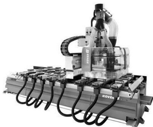
Рис. 2. Экспериментальная установка на базе обрабатывающего центра с числовым программным управлением Rover B 4.35
