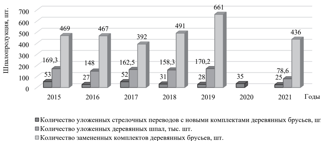
Рис. 1. Объемы укладки деревянных шпал и переводных брусьев на БЖД
