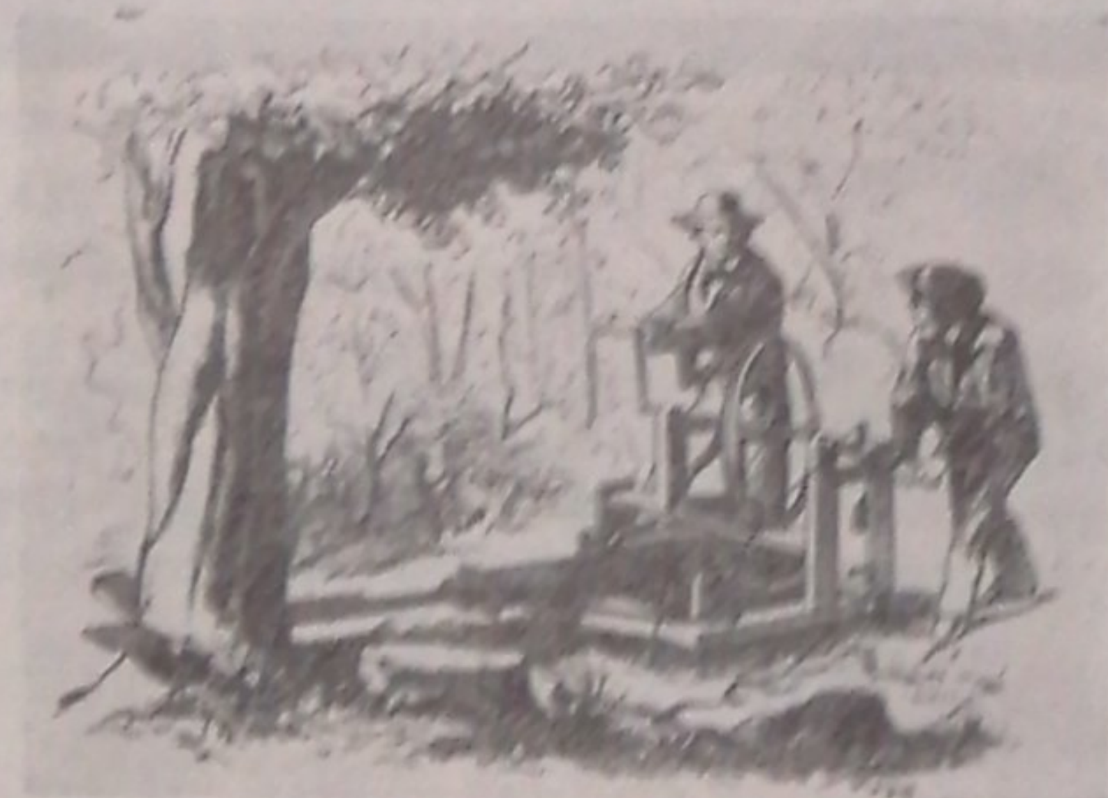
Рис. 6. С шестидесятих годов XIX столетия конструкторы США работают над созданием переносной лесопильной установки для валки крупных деревьев. На рисунке — одна из первых таких установок конструкции 1861 г.
