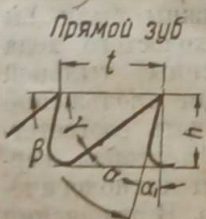
Рис. 2. Профили рамных пил, рекомендуемые ЦНИИМОД для распиловки хвойных пород. Прямой зуб (слева); полуволчий зуб (справа)
