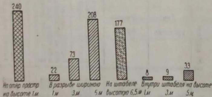
Рис. 2. Испарение с открытой водной поверхности в разрывах между штабелями и в штабелях на различной высоте по середине длины штабеля (в см³ с 1 см² поверхности в час)
