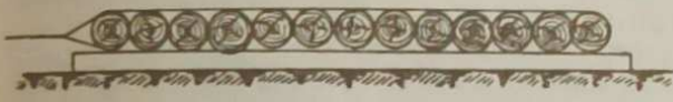
а) укладка в 1 ряд. Длина чокара (с учетом сбега бревен) 2(d + \frac{6,5}{2})n + (d + \frac{6,5}{2})\pi ,
