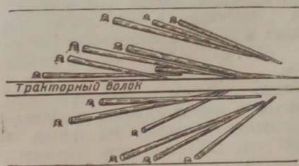
Рис. 3. Схема валки хлыстов вершиной вперед при трелевке волоком
