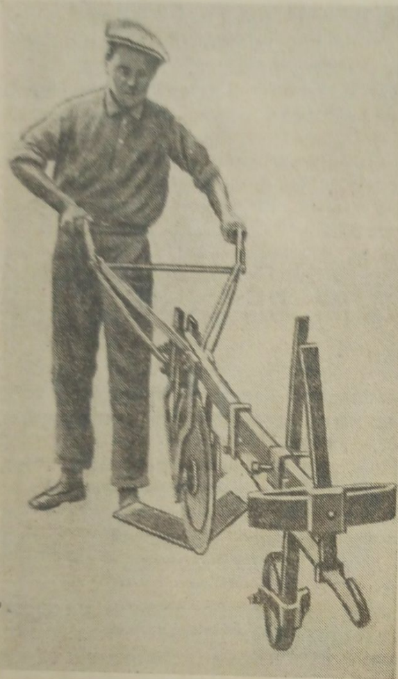
Рис. 1. Лесной культиватор Е. Д. Годнева. Общий вид.
