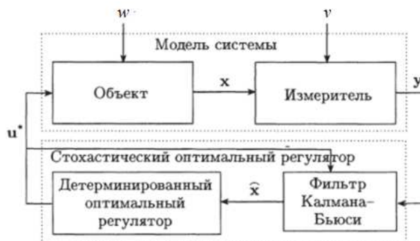
Рисунок 1 - Стохастическая оптимальная система при неполной информации
