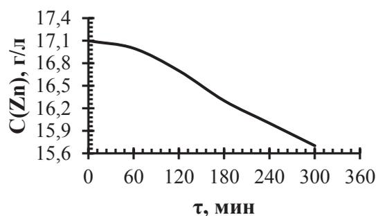
**Рисунок 1 – Изменение концентрации цинка в процессе электроэкстракции**
