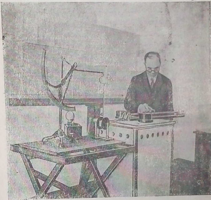
Рис. 3. Малая установка электросушки
