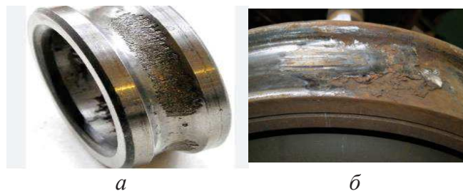
Рисунок 4 – Усталостный износ a – внутренней обоймы подшипника; б – катка
