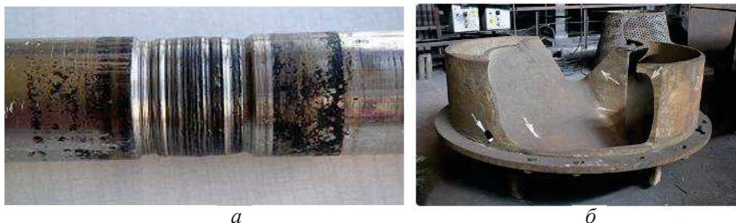
Рисунок 2 – абразивный износ a – вала; б – деталей шаровых мельниц
