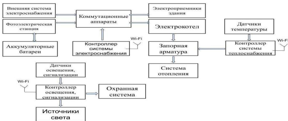
**Рисунок 1 – Структурная схема управления системой «Умный Дом»**
