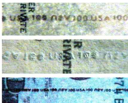
Рисунок 3 – Имитация скрытой защитной нити надпечаткой текста: а – на просвет; б – в косопадающем свете; в – в УФЛ
