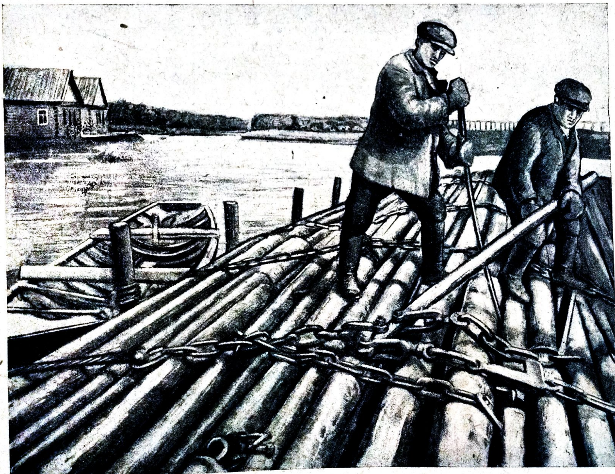
Затяжка обвязочных цепей морского сигарного плота
