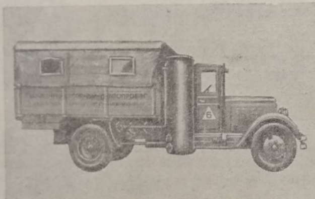
Общий вид газогенераторной машины ЗИС 21 с древесным газогенератором
