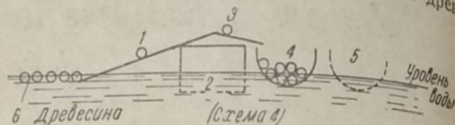
Рис. 4. Схема работы, рассчитанная на повышение производительности сплотночных машин
